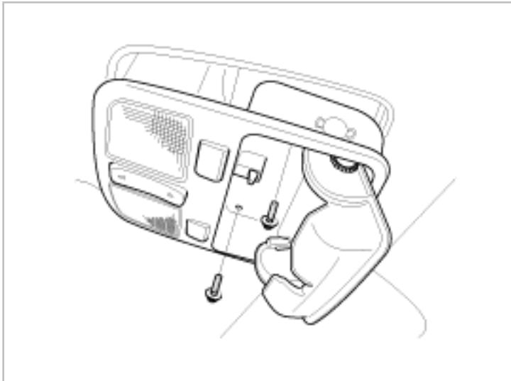
3. 分离天窗开关连接器 (6P) 和阅读灯连接器 (2P),从顶棚内衬上拆卸车顶控制台,检查端子之间的导通状态。如果导通状态不符合规定,更换天窗开关。
